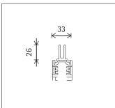
Produktbeschreibung Mit zwei Schrauben. Aluminium, eloxiert. Belastung 30kg. L 50mm, H 26mm.
